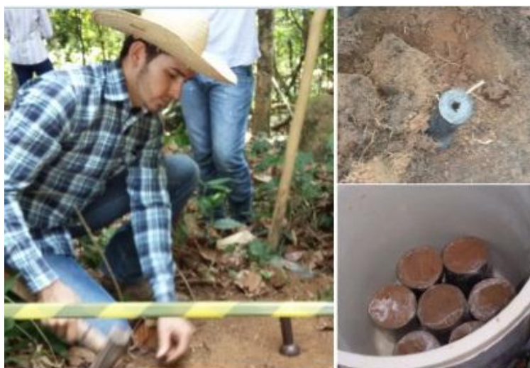
Figura 4: Coleta para avaliação da densidade e porosidade total do solo. Alta Floresta-MT, 2017.
